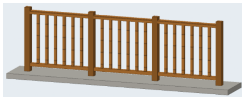
قوائم رأسية متقاربة (صورة 1)
