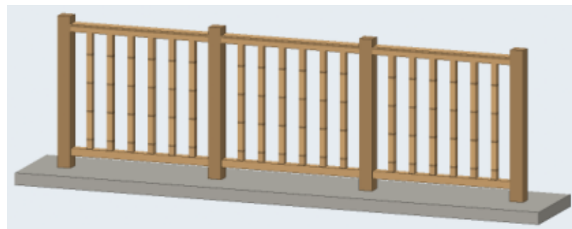
قوائم رأسية متقاربة (صورة 1)
